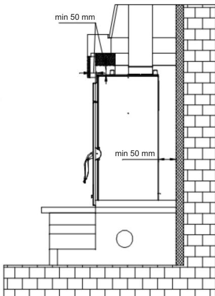
1. Omogućiti konvekciju zraka između uloška i obzida. U tom cilju treba između izolacije stijenki obzida, izvedene od mineralne vune debljine 5 cm i uloška ostaviti razmak minimalno 5 cm.
