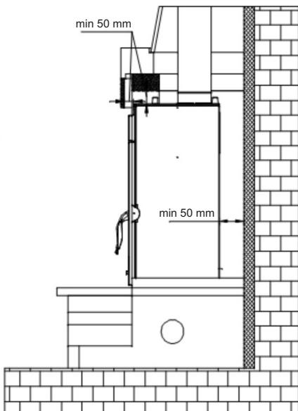
1. Umožnit konvekci vzduchu mezi vložkou a obezdívkou. Za tím účelem je třeba ponechat mezi izolací obezdívky, provedené minerální vlnou o tloušťce 5 cm a vložkou mezera minimálně 5 cm.
