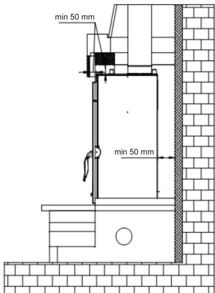
1. Omogočiti konvekcijo zraka med vložkom in obzidavo. Zaradi tega morate med izolacijo stene, ki mora biti iz mineralne volne, debele 5 cm, in vložkom pustiti najmanj 5 cm razmika.
